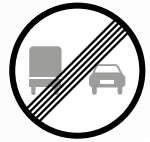
Tr-503 Fin de prohibición de adelantamiento para camiones
