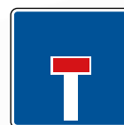
S-15a Preseñalización de calzada sin salida
