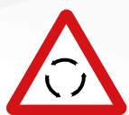
P-4 Intersección con circulación giratoria
