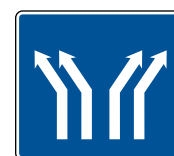
S-63 Bifurcación en calzada de cuatro carriles
